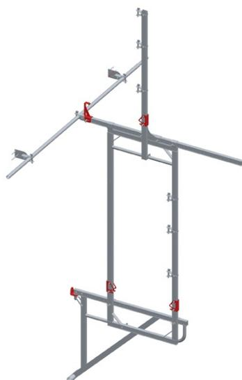
Das Dachgerüst wird an der Unterseite des Daches befestigt, um die Böden und Geländer zu stützen.
